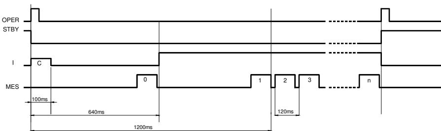
C = Überprüfung der Anschlüsse
